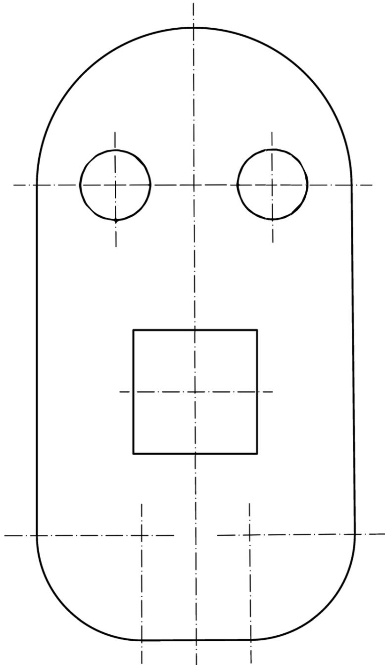
BLOQUE 1. EJERCICIO 4. - VISTAS. Dibuja a mano alzada las vistas (alzado, planta y perfil) de la pieza representada. El hueco de la pieza es pasante.
